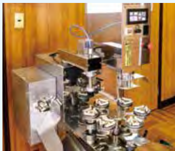
自社製造の皮剥き機 もう一つの事業の柱だ
